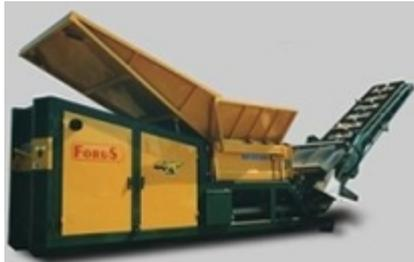
En raison du couple important que doit fournir ce type de machines au démarrage, on utilise des moteurs à rotor bobinés, démarré à l'aide de résistances.
