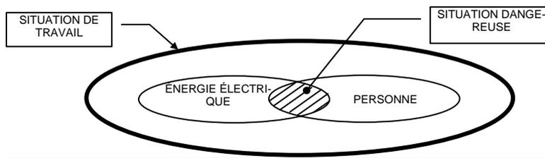
**Voisinage de pièces nues sous tension du domaine BT** : (Cf. chapitre 6.4 de la publication C18-510) « le travail est dit au voisinage lorsque l'exécutant ou les objets qu'il manipule se trouvent dans la zone 4, c'est-à-dire à une distance inférieure à 0,30 m à partir des pièces nues sous tension mais sans qu'il y ait contact intentionnel avec ces pièces nues.
